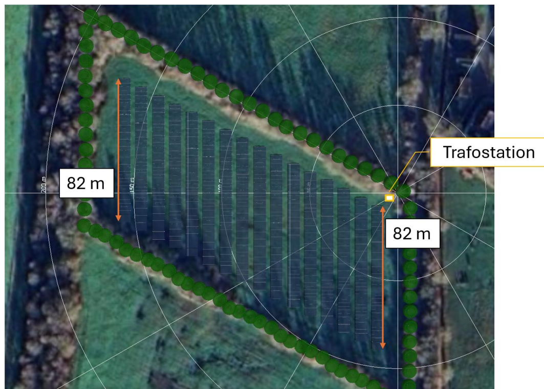
Abbildung 2: Vorplanung der Anordnung der PV-Modulreihen auf dem Flurstück gem. Planungsbüro Graw GmbH & Co. KG
