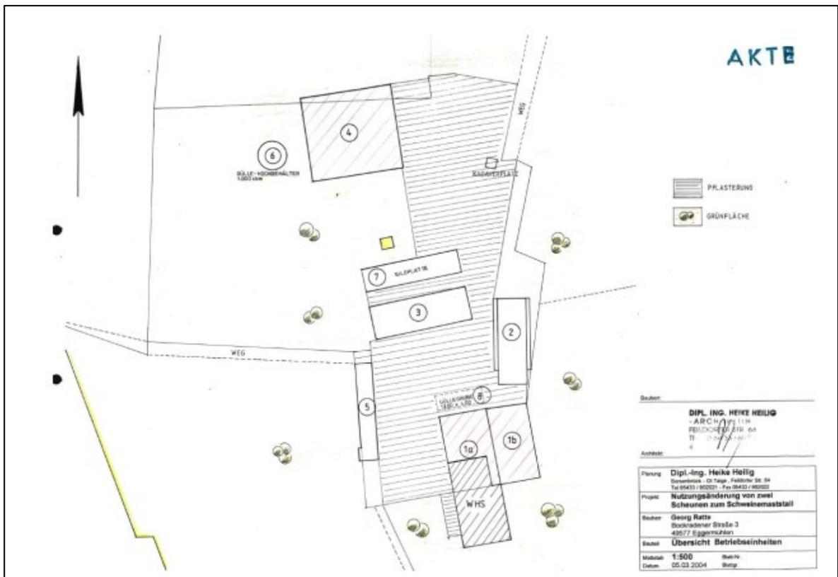
Bild 2: Lageplan der Betriebseinheiten (1a, 1b, 2, 3, 4 Mastställe, 5 Remise, 6 Güllehochbehälter, 7 Siloplatte, 8 Güllegrube) [6]
